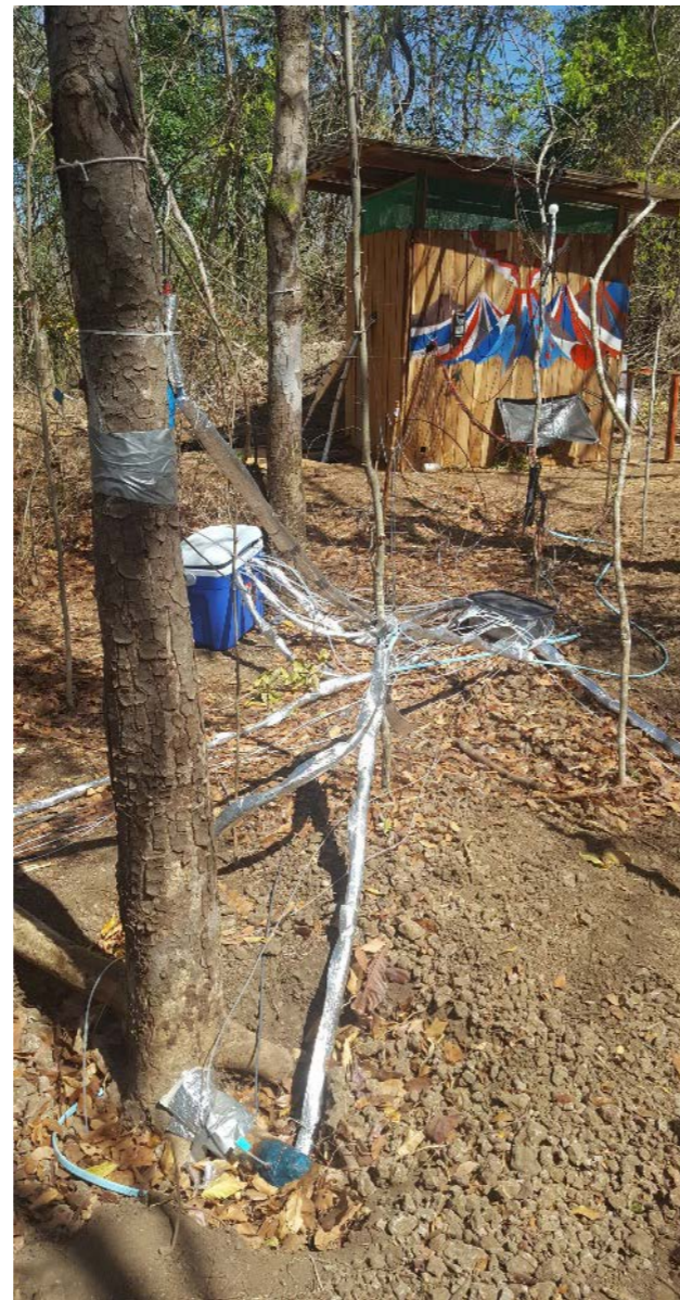
Setup zur Messung stabiler Wasserisotope im Baumxylem auf der Versuchsfläche in Costa Rica
